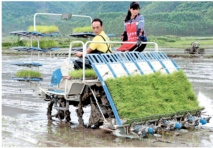
▲4月10日,武宣县水稻生产机械化育插秧技术及山地轨道运输机现场作业演示会,分别在桐岭镇仁汉村农业机械科技示范基地、桐岭镇瑞丰农机专业合作社举行。图为水稻插秧机进行现场演示。(谭文革 覃兰芬 摄)
