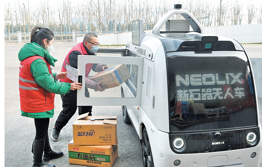
▲1月9日,在西咸新区沣西新城一物流中心,工作人员给无人配送车装货。当日,陕西省西咸新区沣西新城作为试点区域开始用无人车提供物资配送,用于保障封控园区人员基本生活物资供应。无人配送车在单程6.5公里的配送路线上,每天可配送物资6次,单次载重320公斤。 新华社发
