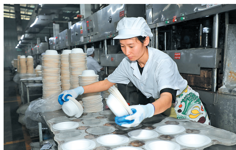
▲4月2日,位于象州县工业园区石龙片区C区的广西家得宝日用品有限公司生产车间内一片繁忙景象。据悉,该公司目前拥有全自动纸浆模塑生产线72台,430名员工,每天24小时可生产餐具180万只,一季度产值预计达2300万元。图为员工在认真检查已成型餐具的产品质量。(黄隆天 摄)
