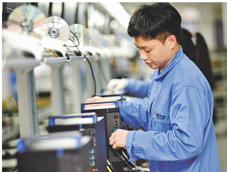
生产线上的计算机正在做出厂前最后的检测。 (玉林日报记者 蒋金泰 摄)
