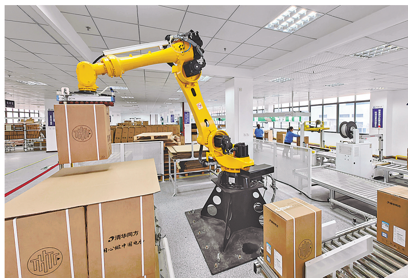
计算机生产线包装区自动高速码垛机器人。 (玉林日报记者 蒋金泰 摄)
