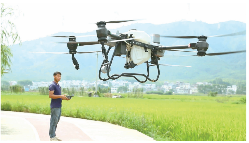
▲在武宣县螺山区区域性水稻示范基地,技术员操作一台植保无人机在稻田里开展农药喷洒作业,仅用几分钟就能完成一亩地的农药喷洒工作。
