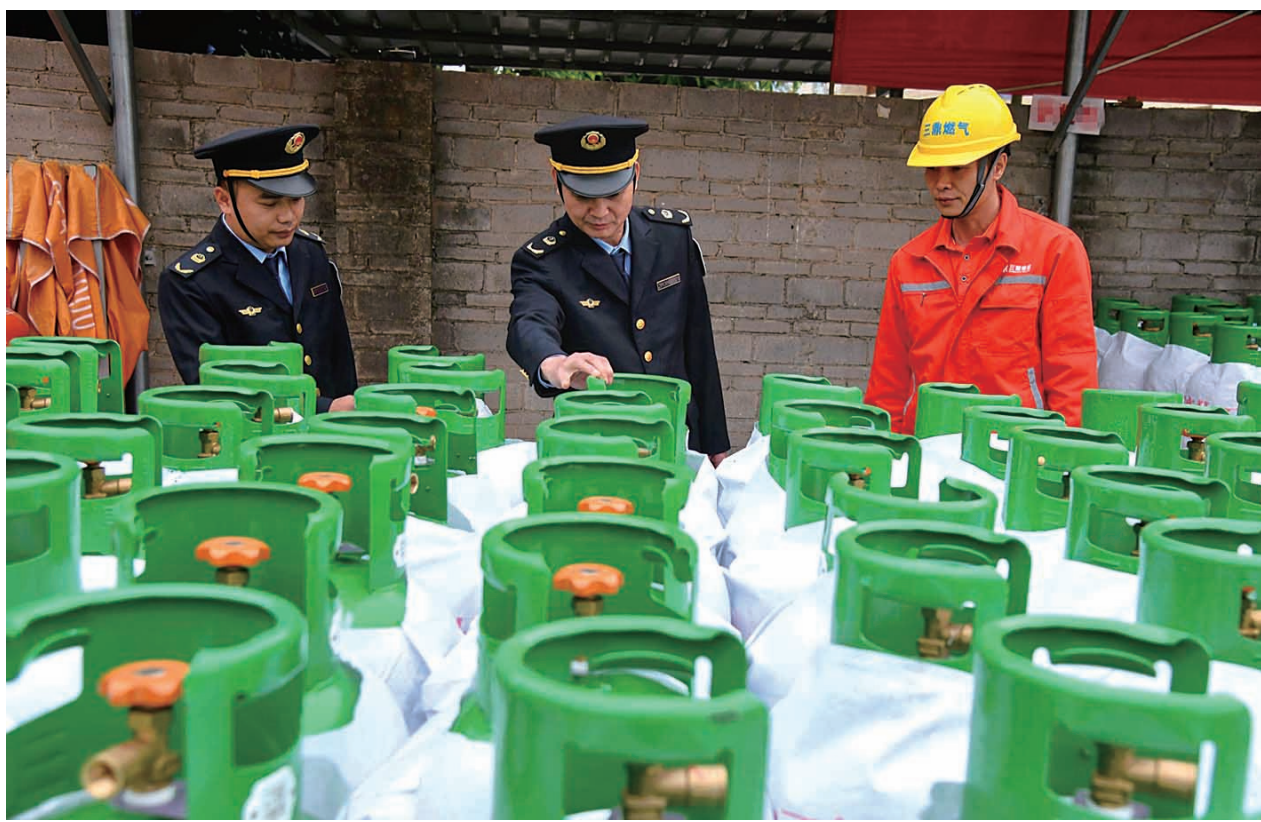
▲执法人员在燃气经营企业对石油液化气钢瓶开展安全检查。
