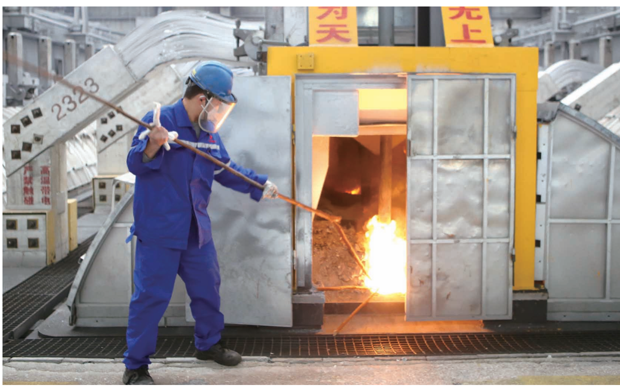
▲来宾广投银海铝业电解车间工作人员正在进行熄灭阳极效应作业。
