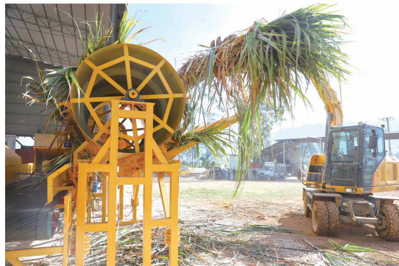
▲抓机将甘蔗放入分布式收机器进行除杂和切断等处理。
