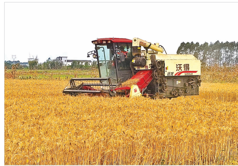
▲联合收割机穿梭田间，收割快速掠过麦垄，实现脱粒、秸秆粉碎一体化高效作业。
